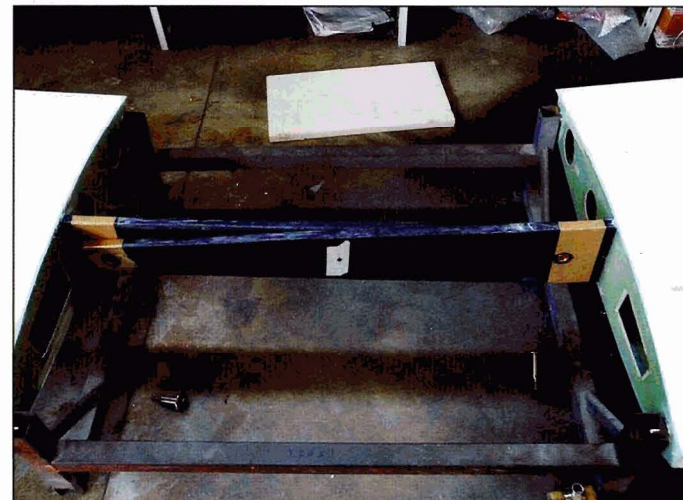
Carbon-Verbindungssteile: Tragfläche ist in 20 Min. demontierbar.
